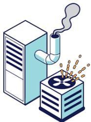
Además, hay una Unidad de Aire de Recuperación (MAU) que ayuda con el sistema de ventilación de la escuela. Proporciona aire fresco al interior del edificio y evita la acumulación de contaminantes del aire interior. Reemplaza el aire perdido por los extractores de aire de la cocina que también están en el techo.
