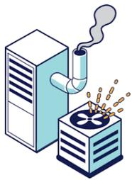
Além disso, há uma Unidade de Ar de Maquiagem (MAU) que ajuda com o sistema de ventilação da escola. Fornece ar fresco ao interior do edifício e evita a acumulação de contaminantes de ar interior. Ele substitui o ar perdido pelos exaustores da cozinha que também estão no telhado.
